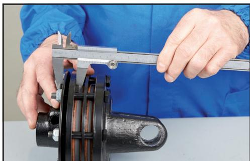
5. Avvitare progressivamente i bulloni (ad esempio mezzo giro per ogni bullone) in modo da comprimere uniformemente la molla fino all'altezza  $h$  prevista. Le tabelle nella pagina seguente forniscono i valori dell'altezza  $h$  della molla in funzione del tipo di limitatore e della taratura richiesta.
