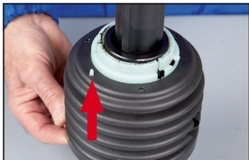
3. Montare la fascia ondulata infilando il perno di riferimento della ghiera nell'apposito foro della fascia.
