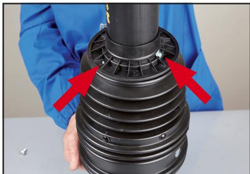
6. Montare l'imbuto base con il tubo infilando il perno di riferimento della ghiera nel foro ricavato sull'imbuto base. L'ingrassatore della ghiera risulta nel foro dell'imbuto base.
