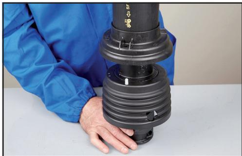
4. Montare l'imbuto base con il tubo infilando l'ingrassatore nel foro ricavato sull'imbuto base.
