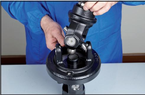
10. Montare la forcella sul corpo centrale infilando la sfera di centraggio e i perni della crociera nelle apposite sedi.
