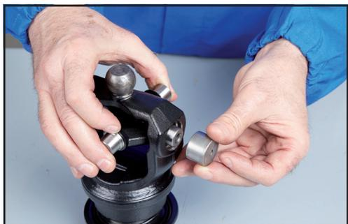
3. Montare il cuscinetto con il foro per l'ingrassatore. Infilarlo sul perno della crociera e poi spingerlo parzialmente nella propria sede con la pressa.
