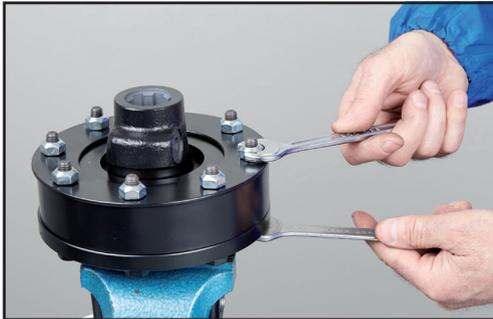
2. Svitare tutti bulloni progressivamente in modo da ridurre le spinte delle molle in modo uniforme e progressivo.
