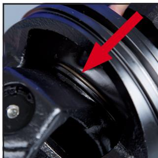
15. Spingere con un dito la protezione in gomma e l'anello di rinforzo se previsto dentro l'alloggiamento realizzato sulla forcella interna.
