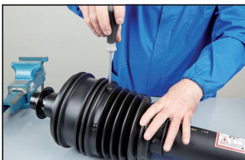
1. Ingrassare la sede ed installare l'anello di supporto della protezione. Posizionare l'anello di supporto sul giunto omocinetico con le borchie rivolte verso la forcella interna. L'anello è dotato di ingrassatore che è utilizzato solo per giunti omocinetici 50°. Non considerare l'ingrassatore dell'anello grande per la protezione di giunti 80°.
