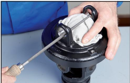
14. Durante le fasi di smontaggio è possibile che si formino delle piccole bave sulle superfici di imbocco degli occhi delle forcelle. Eliminare le bave con una lima tonda, proteggendo il disco di centraggio del corpo centrale da eventuali particelle metalliche che potrebbero comprometterne il funzionamento.
