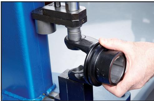
9. Inserire parzialmente il terzo cuscinetto con il foro per l'ingrassatore in una delle sedi della forcella interna.
