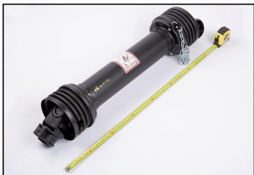
6. Verificare la lunghezza della trasmissione nelle condizioni di allungamento minimo e massimo sulla macchina. In condizioni di lavoro i tubi devono sovrapporsi per almeno 1/2 della loro lunghezza. Anche quando la trasmissione non è in rotazione, i tubi telescopici devono mantenere una sovrapposizione adeguata per evitare impuntamenti.
