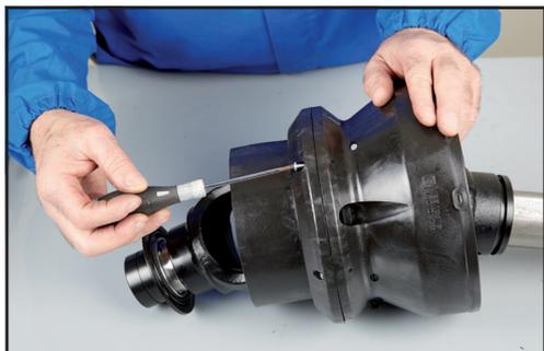
1. Lubrificare le piste di strisciamento sul corpo centrale del giunto. Posizionare gli anelli di supporto e i semigusci sul giunto e fissarli con le apposite viti.
