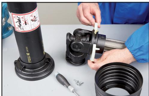
2. Montare l'anello di supporto nella gola con l'ingrassatore rivolto verso il tubo di trasmissione.
