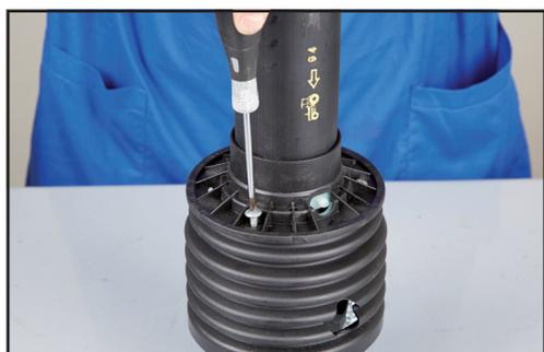
5. Avvitare le viti di fissaggio.
