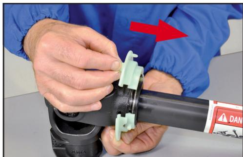
2. Montare la ghiera di supporto nella gola con il perno di riferimento rivolto verso il tubo di trasmissione.
