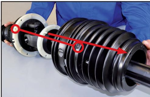
4. Infilare la fascia di protezione allineando i fori per le viti con le borchie dell'anello di supporto grande ed il foro sul fondo con l'ingrassatore dell'anello piccolo.
