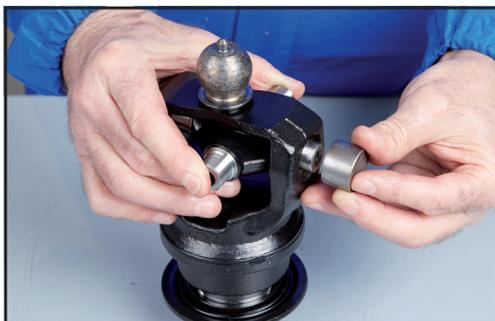
3. Infilare il cuscinetto con il foro per l'ingrassatore in uno degli occhi della forcella curandone l'allineamento anche con il perno della crociera, quindi con la pressa inserirlo parzialmente nella propria sede.
