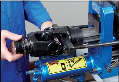
8. Iniziare l'introduzione, verificando la coassialità tra tubo e forcella interna. Completare il montaggio evitando di forzare a fine corsa il tubo contro la staffa.
