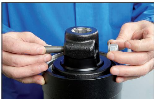
9. Rimontare il perno conico.
