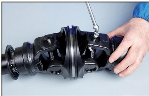
La procedura mostra le operazioni di smontaggio della forcella esterna di un giunto omocinetico 50° Serie SFT dimensione S8.
