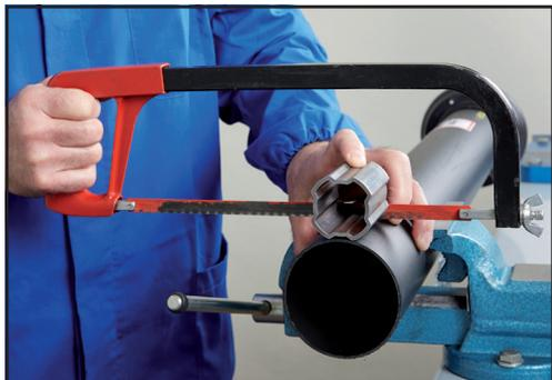
4. Tagliare i tubi di protezione uno alla volta della stessa lunghezza asportata dai tubi di trasmissione.
