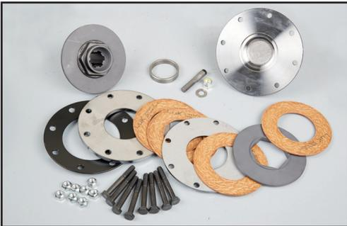
Nota: i dischi di attrito hanno uno spessore nominale di 3,2 mm. Si raccomanda di sostituirli quando lo spessore si riduce a 2,5 mm.
