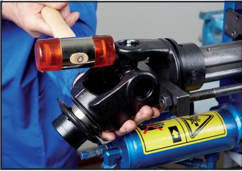
6. Imboccare il giunto sul tubo utilizzando un mazzuolo.
