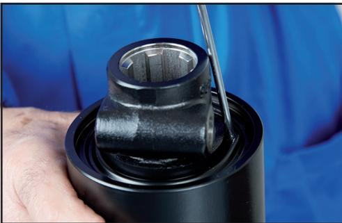
4. Solo per le versioni RL a lubrificazione permanente. Con l'ausilio del cacciavite rimuovere l'anello di tenuta. Prestare attenzione a non danneggiare o segnare il labbro di tenuta dell'anello. L'anello di tenuta è senza rinforzo metallico, perciò è possibile deformarlo per farlo passare sopra la sede del bullone conico.
