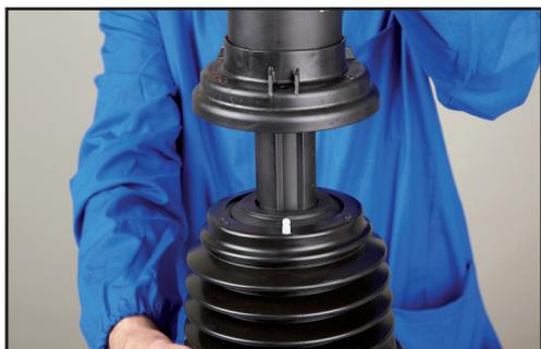
9. Montare l'imbuto base con il tubo infilando l'ingrassatore nel foro ricavato sull'imbuto base.
