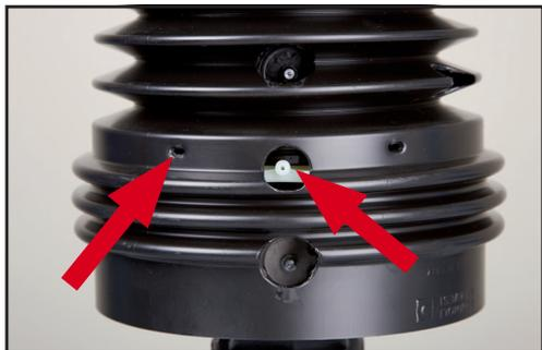
7. Solo per giunti omocinetici 50°: verificare che i fori radiali della fascia di protezione siano allineati con i fori ricavati nelle borchie dell'anello di supporto e che il foro aggiuntivo della fascia corrisponda all'ingrassatore dell'anello di supporto.
