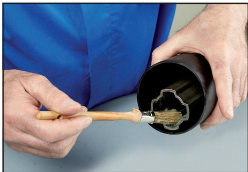
Separare le due parti della trasmissione ed ingrassare manualmente gli elementi telescopici se non è previsto un ingrassatore per questo scopo.
