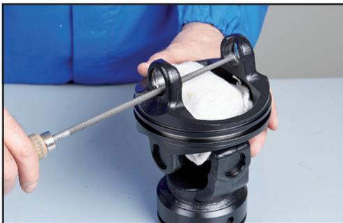
15. Durante le fasi di smontaggio è possibile che si formino delle piccole bave sulle superfici di imbocco degli occhi delle forcelle. Eliminare le bave con una lima tonda, proteggendo la sede della sfera di centraggio da eventuali particelle metalliche che potrebbero compromettere il funzionamento del giunto.
