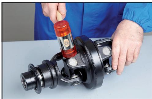
12. Assestare i giunti mediante alcuni colpi sui bracci del corpo centrale. Verificare l'articolazione del giunto. Il giunto deve angolarsi senza impuntamenti in tutte le direzioni.
