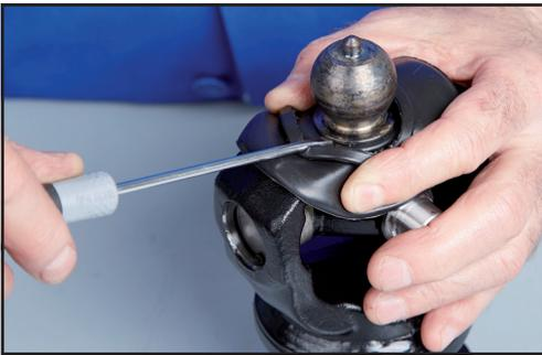
9. Montare con l'ausilio di un cacciavite la protezione in gomma sulla forcella esterna. Assicurarsi che la protezione sia correttamente infilata nella propria sede.
