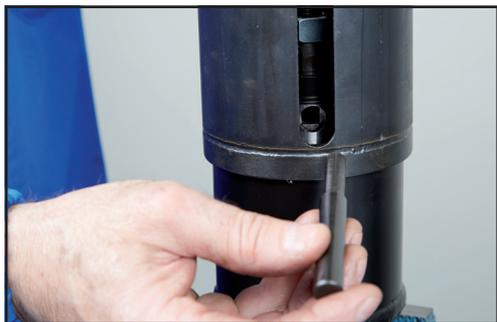
9. Infilare il perno nel foro del mozzo che coincide con il foro realizzato sulla spina scanalata dell'estrattore.
