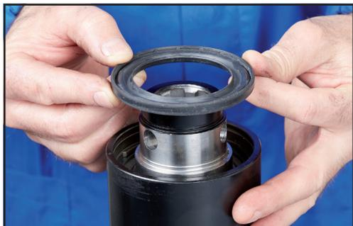
8. Solo per le versioni LC e LT a lubrificazione stagionale. Installare l'anello di tenuta come mostrato in figura. Prestare particolare attenzione alla posizione di montaggio dell'anello. Il labbro deve essere rivolto verso l'esterno per impedire alla sporcizia di entrare nel limitatore.
