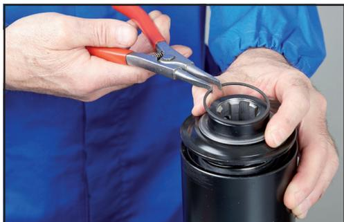
12. Infilare l'anello di manovra del collare a sfere e tenendolo premuto posizionare l'anello elastico nella apposita sede. Assicurarsi che il collare a sfere funzioni correttamente.
