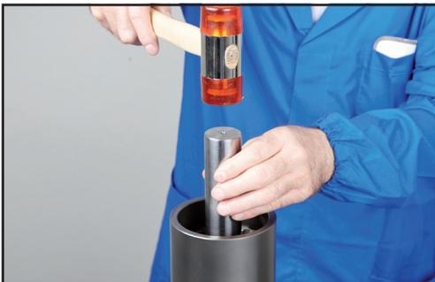
6. Allineare il profilo del disco di chiusura con il corpo esterno del limitatore e montarlo.
