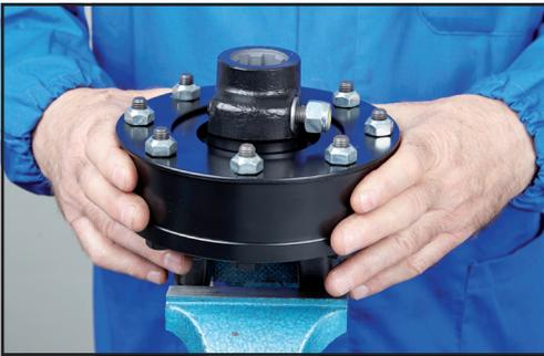
5. Avvitare progressivamente i bulloni (ad esempio mezzo giro per ogni bullone) in modo da comprimere uniformemente la molla fino a portarla in aderenza alla fascia di regolazione metallica.
