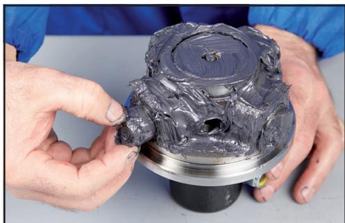
4. Sfilare le camme come mostrato in figura per liberare il kit di taratura interno. Non è necessario sfilare le camme completamente.
