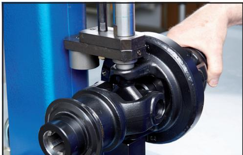
3. Avvicinare il blocchetto mobile a quello fisso. Utilizzando il pressore smuovere uno degli anelli elastici montato sui bracci del corpo centrale.
