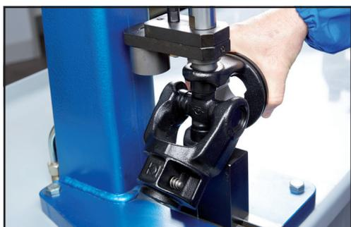
La procedura mostra le operazioni di smontaggio di un giunto SFT.
