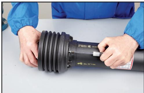
5. Avvitare le viti di fissaggio.
