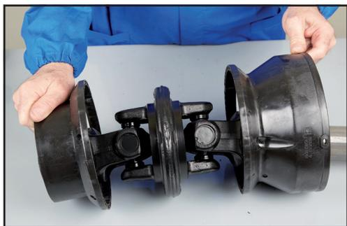
2. Separare i semigusci e sfilarli dal giunto. Controllare i componenti, sostituire eventuali parti usurate.
