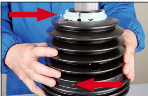
1. Ingrassare le sedi ed installare le ghiera di supporto della protezione. Posizionare la ghiera sulla forcella interna con il perno di riferimento rivolto verso il tubo di trasmissione.
