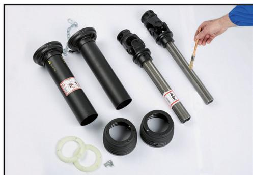
5. Ingrassare il tubo interno di trasmissione e rimontare la trasmissione.
