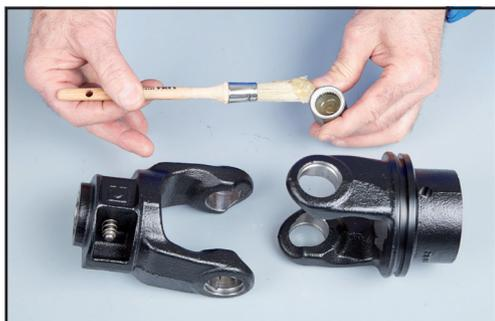
La procedura mostra le operazioni di montaggio di un giunto SFT.
