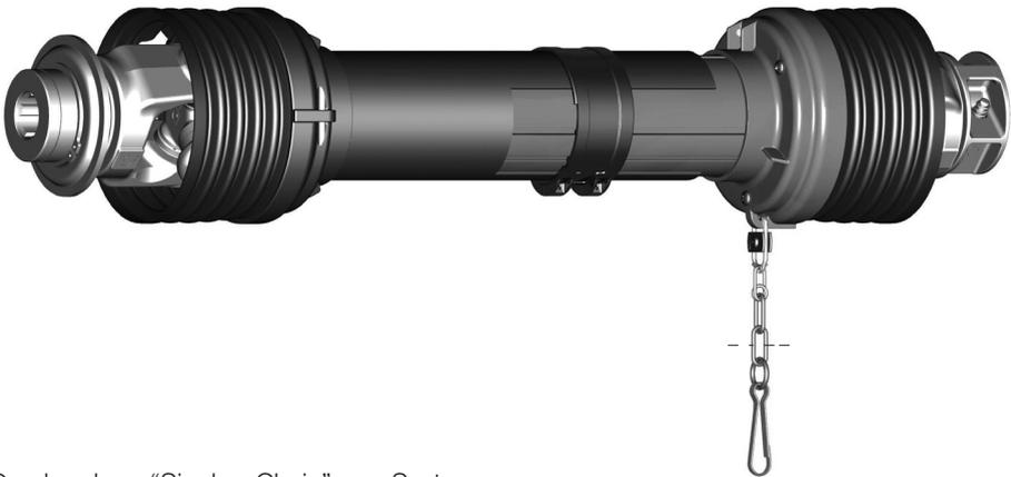
Durch das "Single Chain" - System können sich die Unfallschutzrohre bei Längenveränderungen axial bewegen, sie können aber nicht unabhängig voneinander drehen. Eine einzige, maschinen-seitige Kette verhindert somit die Drehung der Unfallschutzvorrichtung, wie von der Maschinenrichtlinie vorgeschrieben.
