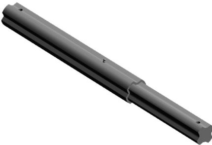
Die “Zähne” des Profils stehen auf 85° zu 95°, um sicherzustellen, dass die Gabeln der Gelenke beim Ineinanderschieben der Profile stets fluchten.
