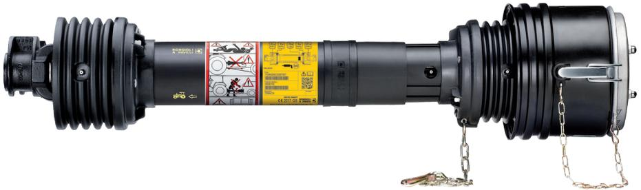
Die Endmanschetten des SFT-Schutzes überdecken die Innengabeln (gemäß Maschinenrichtlinie 2006/42/CE) über ihre volle Länge, ausgenommen bei den Kupplungstypen FFV, die nur für Gelenkwellen ohne CE-Zeichen lieferbar sind. Die SFT-Vorrichtungen sind so gestaltet, dass sie einen angemessenen Gelenkwinkel erreichen, bevor sie die Schutzvorrichtung berühren.
