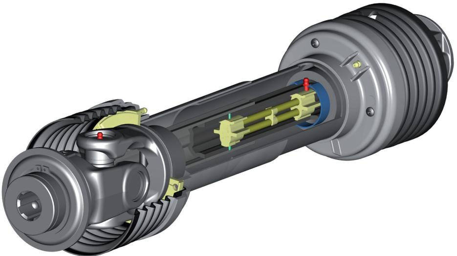
Die Fettaustrittsöffnungen sind mittig im Profilrohr-Überdeckungsbereich gesetzt, wenn die Gelenkwelle auf die Arbeitslänge Lw gemäß den Angaben der Tabellen "Auszugsängen" ausgezogen ist. Ein Distanzring fungiert als Anschlag für das Außenrohr und verhindert, dass der Schmiernippel bei zusammenschobener Gelenkwelle beschädigt wird.
