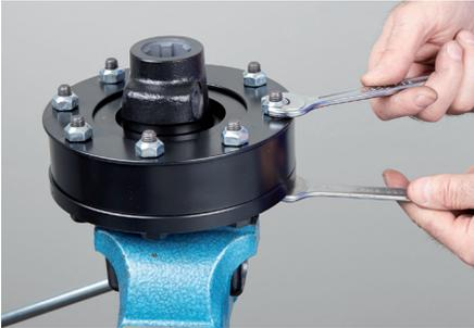
Die Einstellung ist korrekt, wenn die Feder an dem Ring gerade eben anliegt.
