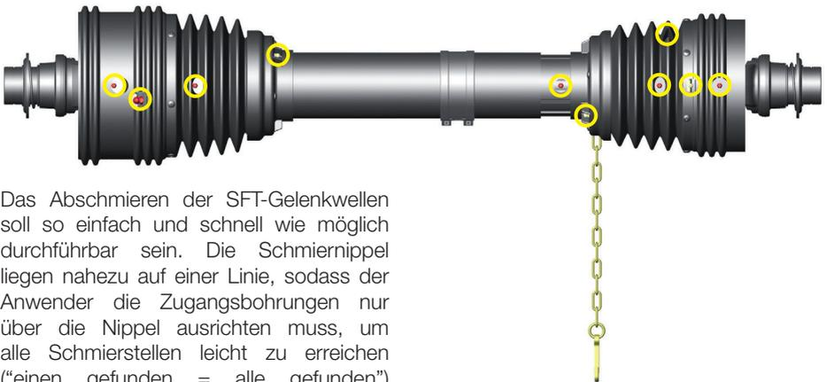
Das Abschmieren der SFT-Gelenkwellen soll so einfach und schnell wie möglich durchführbar sein. Die Schmiernippel liegen nahezu auf einer Linie, sodass der Anwender die Zugangsbohrungen nur über die Nippel ausrichten muss, um alle Schmierstellen leicht zu erreichen ("einen gefunden = alle gefunden")
