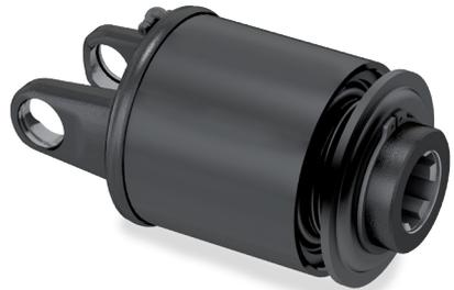
Die dreh sinnabhängige Standardausführung ist so gebaut, dass sie die anzutreibende Welle links herum dreht. Dies ist der Fall, wenn die Kupplung maschinenseitig an der Gelenkwelle montiert ist, die von der Schlepper-Heckzapfwelle auf die Maschinenein-gangswelle treibt.
