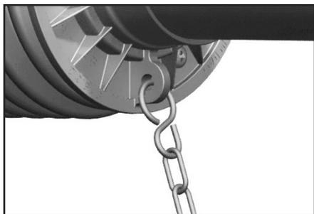
Se o comprimento da corrente não tem sido regulada corretamente e a tensão se torna excessiva, por exemplo durante as manobras da máquina, o gancho a “S” de ligação abre-se e a corrente se separa da proteção.
