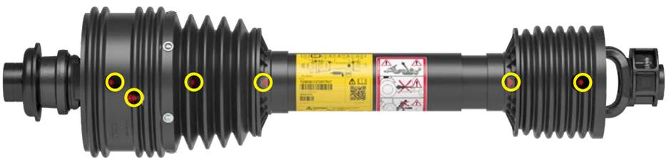
A lubrificação dos cardans Global é estudada para ser a mais simples e rápido possível. Os engraxadores são alinhados ou em posição aproximada a fim de que o usuário possa alinhar os furos da proteção com os engraxadores e efetuar facilmente a lubrificação de todos os componentes.
