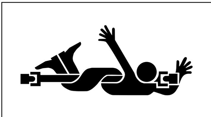
Ne pas s'approcher de la zone de travail ou des pièces en cours de rotation. Éviter de porter une tenue de travail dotée de ceintures, pans ou parties flottantes qui pourraient faire prise. Le contact avec des éléments en cours de rotation peut provoquer des accidents graves, voire mortels.
