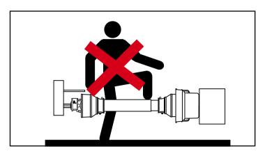
Не используйте карданную передачу в качестве опоры или подножки.
