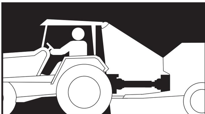
Обеспечьте освещение рабочего участка передачи во время установки и ночного использования, а также при плохой видимости.
