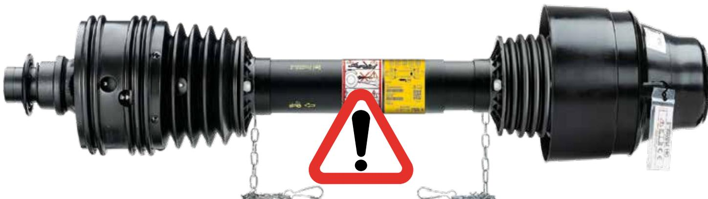
**ALL ROTATING PARTS MUST BE SHIELDED. THE TRACTOR MASTER SHIELD, THE DRIVELINE GUARD, AND THE IMPLEMENT SHIELD ALL WORK TOGETHER FOR YOUR SAFETY.**
