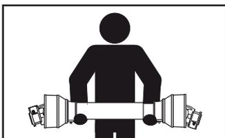
Trasportare la trasmissione mantenendola orizzontale per evitare che lo sfilamento possa provocare incidenti o danneggiare la protezione. In funzione del peso della trasmissione utilizzare adeguati mezzi di trasporto.
