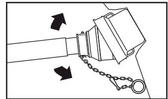
Fissare le catene di ritengo della protezione. Le migliori condizioni di funzionamento si hanno con la catena in posizione radiale rispetto alla trasmissione. Regolare la lunghezza delle catene in modo che permettano l'articolazione della trasmissione in ogni condizione di lavoro, di trasporto e di manovra. Evitare che le catene si attorciglino attorno alla trasmissione per eccessiva lunghezza.
