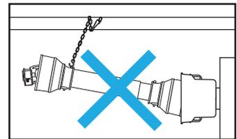
Non utilizzare le catene per trasportare o sostenere la trasmissione cardanica al termine del lavoro. Usare un apposito supporto.
