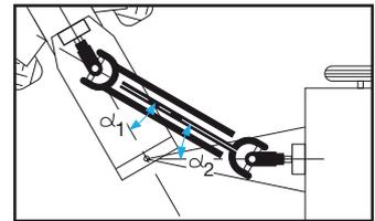
ni previste senza interferire con il trattore o con la macchina. Il contatto con parti del trattore, ganci o perni di traino, attacchi a tre punti, danneggia la protezione dell'albero cardanico. Non utilizzare trattori, o sistemi di collegamento alla macchina che interferiscano con l'albero cardanico durante le sue articolazioni. Non utilizzare adattatori o componenti non previsti dal costruttore della macchina.
