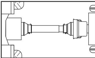
Tutte le parti in rotazioni devono essere protette. Le protezioni del trattore e della macchina devono costituire un sistema integrato con la protezione della trasmissione cardanica.
