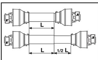
I tubi telescopici devono sovrapporsi per almeno 1/2 della loro lunghezza in normali condizioni di lavoro e devono sovrapporsi per almeno 1/3 della loro lunghezza in ogni condizione di lavoro. Anche quando la trasmissione non è in rotazione, i tubi telescopici devono mantenere una sovrapposizione adeguata per evitare impuntamenti.
