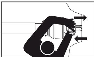
Prima di iniziare il lavoro assicurarsi che la trasmissione cardanica sia correttamente fissata al trattore ed alla macchina. Controllare il serraggio di eventuali bulloni di fissaggio.
