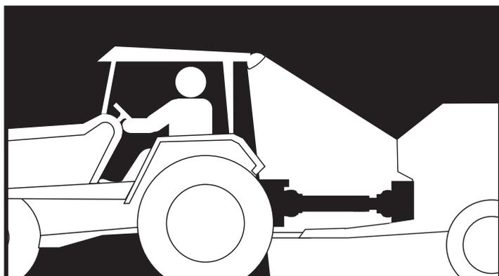
Eclairer la zone de travail de la transmission durant les phases d'installation et d'utilisation, en cas d'utilisation nocturne ou de faible visibilité.
