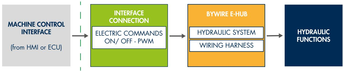
ByWire HUB è un sistema integrato per la gestione e il controllo delle valvole ByWire attraverso un unico punto di collegamento. ByWire HUB è disponibile in tre versioni.
